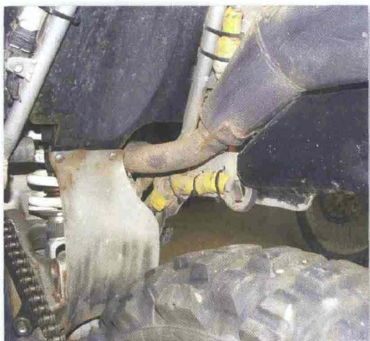
Sbirciando sotto al parafango posteriore troviamo due chiavi di scorta per lo smontaggio delle ruote.
