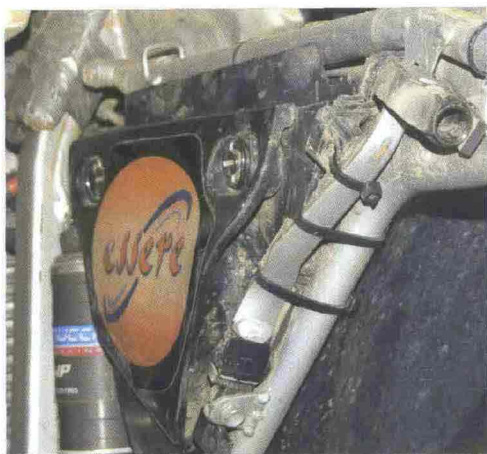
Al telaio posteriore è fissata la leva del cambio.
